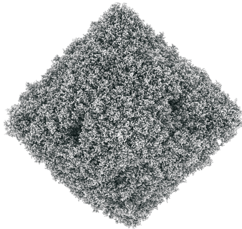
Abbildung 6.2: Anisotroper DLA-Cluster aus 400 000 kugelförmigen Partikeln
